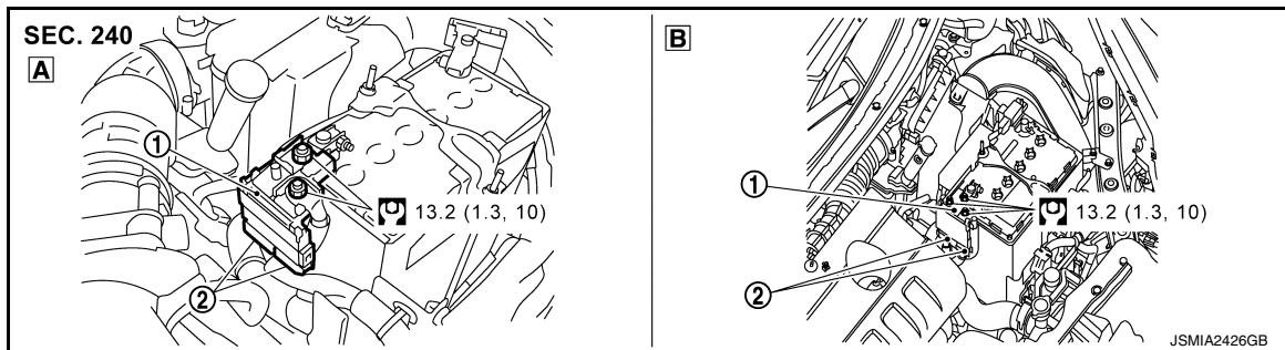
① 带熔断线的蓄电池端子
